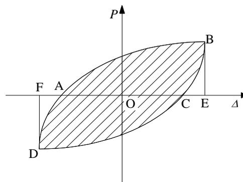
Fig. 14 Equivalent viscous damping coefficient  $h_e$ .
