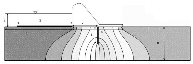
Fig. 4 Definition of parameters
